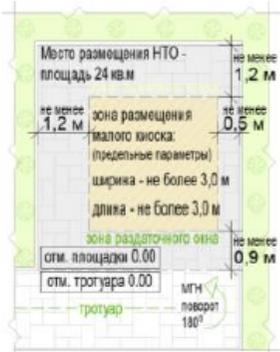
$$S_{\text{НТО}} = \Delta_{\text{НТО}} (1,2 + 3 + 0,5) \times \text{Ш}_{\text{НТО}} (0,9 + 3 + 1,2) = 4,7 \times 5,1 = 23,97$$
