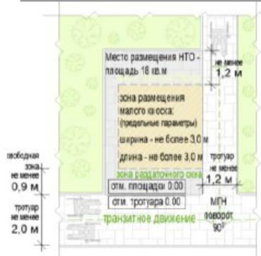
$$S_{\text{НТО}} = \Delta_{\text{НТО}} (0,5 + 3 + 0,0) \times \text{Ш}_{\text{НТО}} (0,9 + 3 + 1,2) = 3,5 \times 5,1 = 17,85$$
