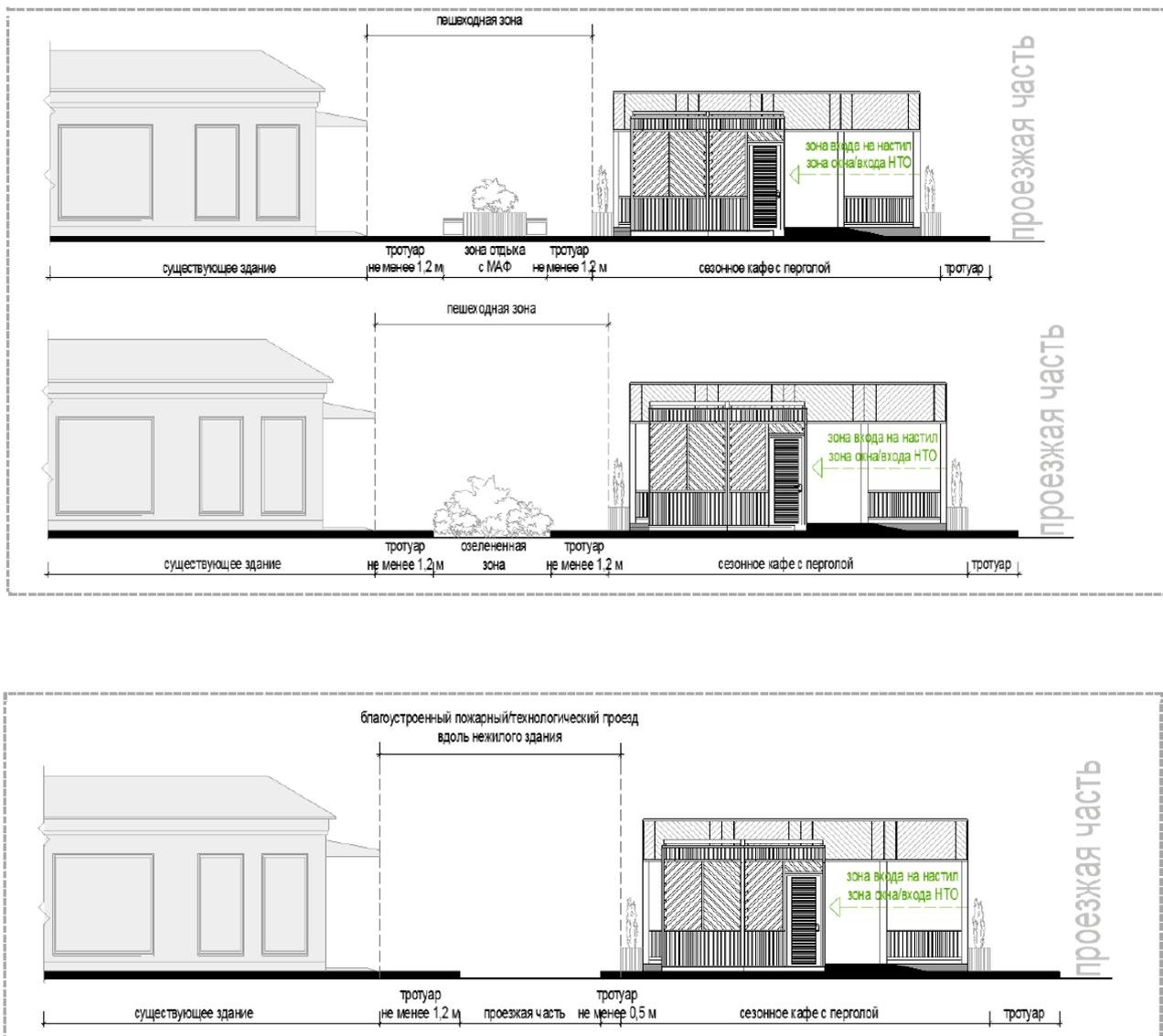
Материал каркаса устраиваемых зонтов, пергол: металл, композитные материалы, дерево (поверхность с декоративным слоем, устойчивым к атмосферным и механическим воздействиям, неоднократному мытью агрессивными растворами и щетками).
